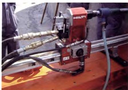
图1 DD-750HY 型液压金刚石钻机
