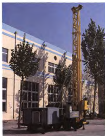
图1 分体式XD-3型全液压动力头钻机
