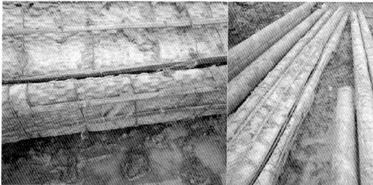
图2 被挤毁的桥式过滤器
