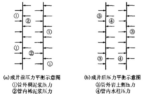
图1 成井前后压力平衡示意图
