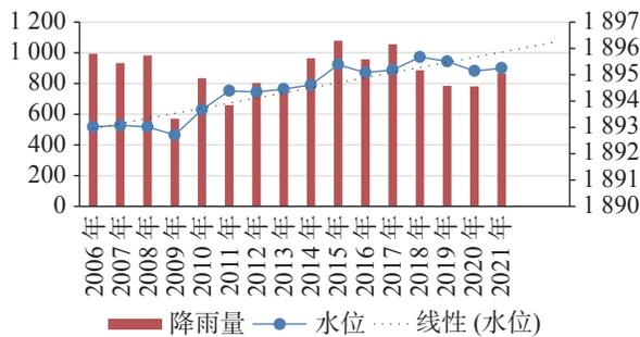
图 3 孔隙水水位、降雨量年均变化图
