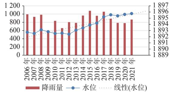
图 4 岩溶水水位、降雨量年均变化图
