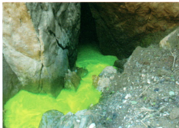
图 2 瓦白白消水洞示踪剂投放照片
