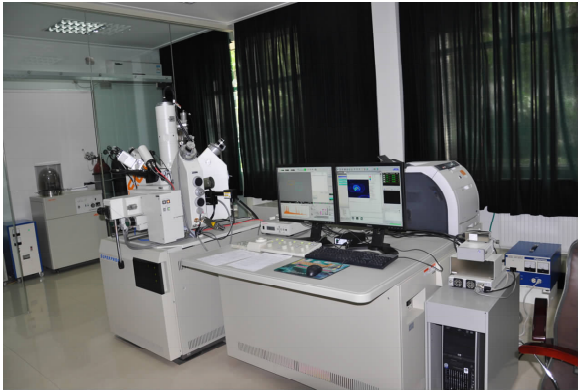
图 2 JXA-8230 型电子探针
