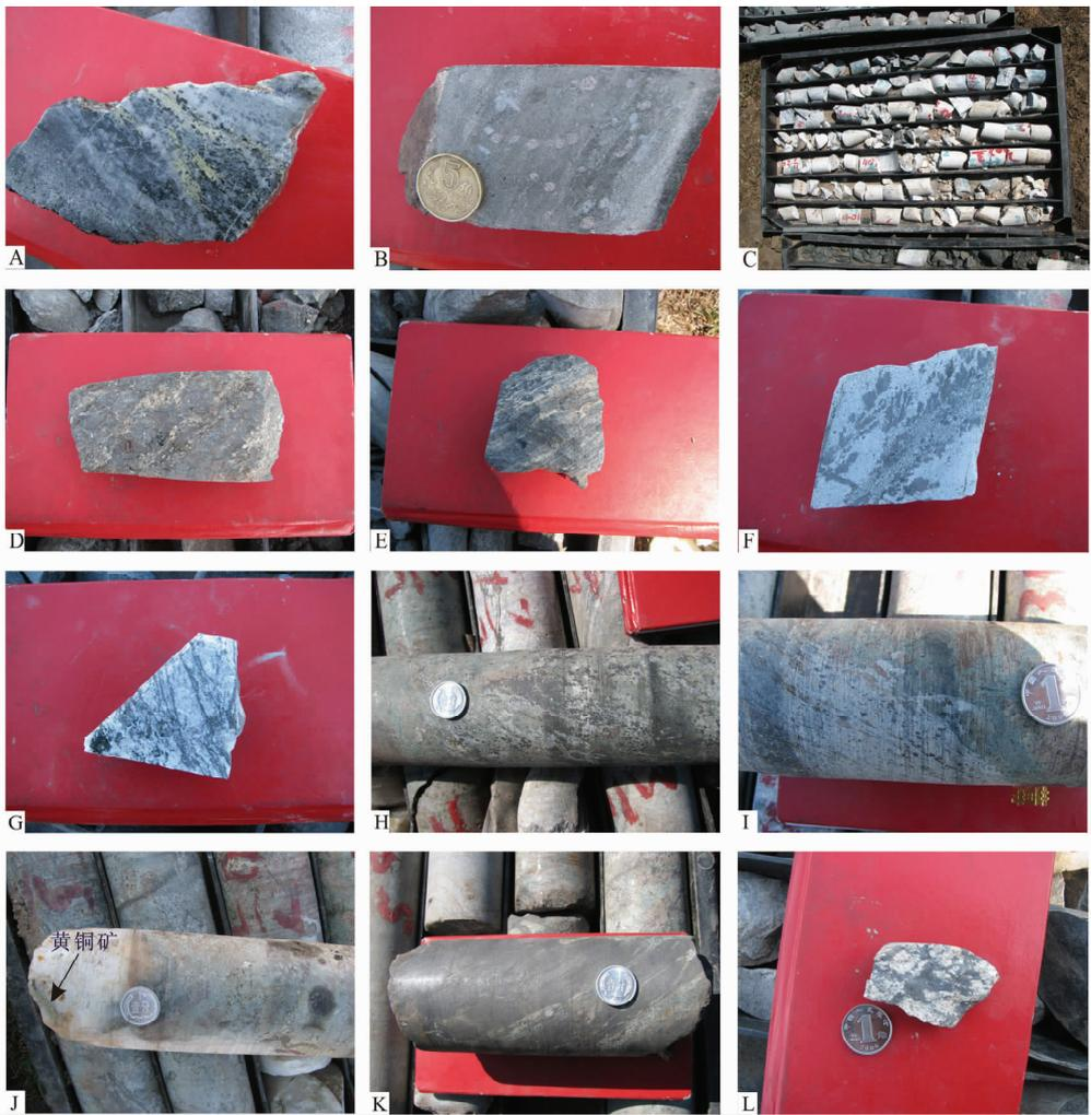
图 2 托莫尔特铁(锰)矿围岩蚀变及矿石特征
