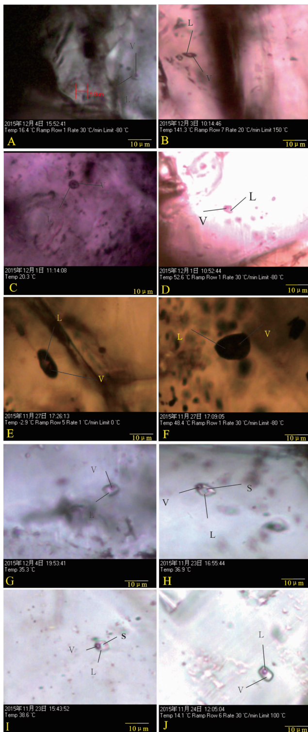
A、B. ZK4803-21 石榴子石中气-液两相包裹体(硅酸岩阶段);C、D. ZK4803-1 石榴子石中气-液两相包裹体(硅酸岩阶段);E、F. ZK4803-23 闪锌矿中气-液两相包裹体(硅酸岩阶段);G. ZK4803-46 石英中气-液两相包裹体(硅酸岩阶段);H. ZK4803-47 方解石中含食盐子晶的三相包裹体(硅酸岩阶段);I、J. ZK4803-29 方解石中的两相包裹体(碳酸盐阶段);L. 气相, B. 液相, V. 固相
