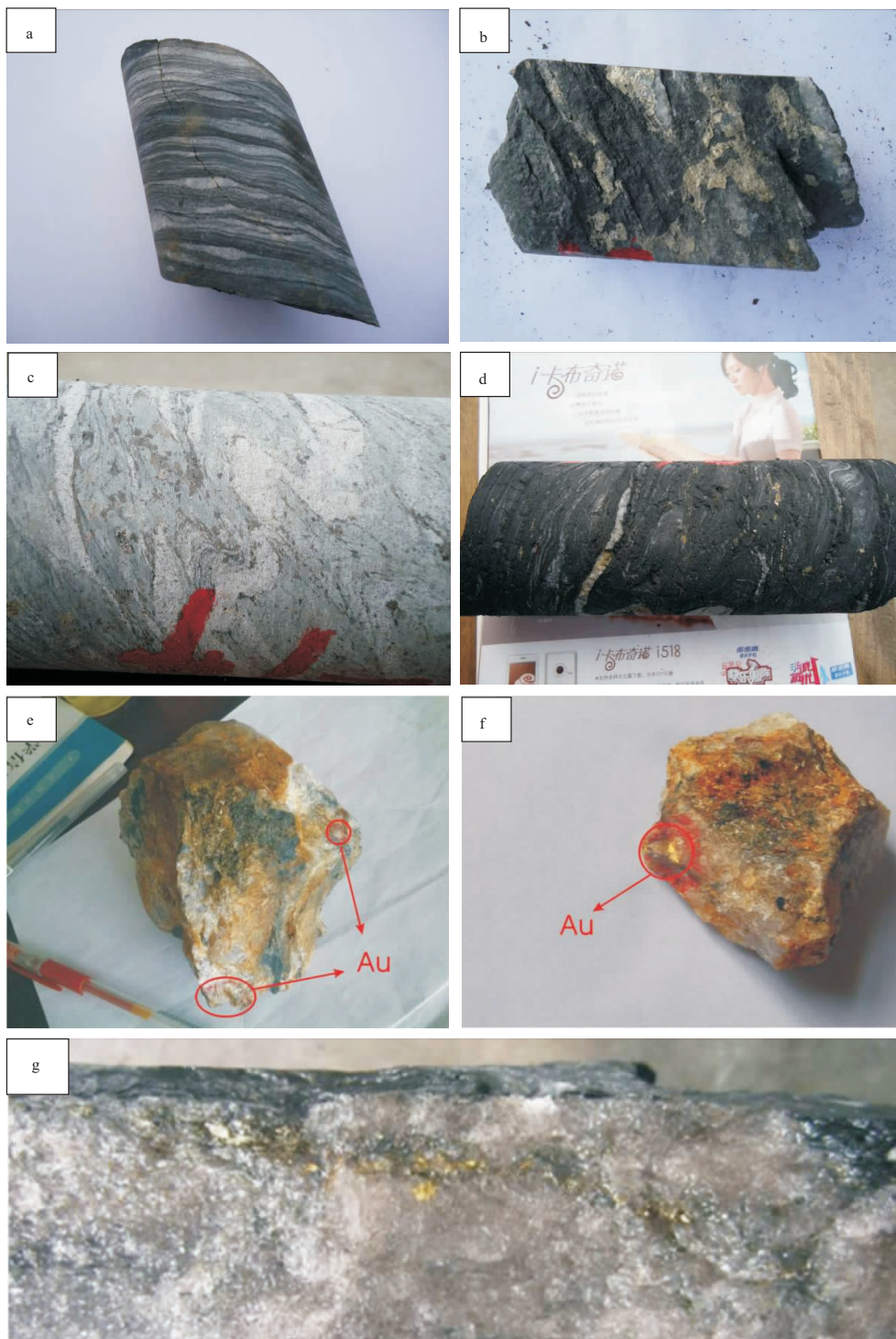
a. 硅化;b. 黄铁矿化;c. 黑云母化;d. 碳化;e、f、g. 石英脉粒间明金
