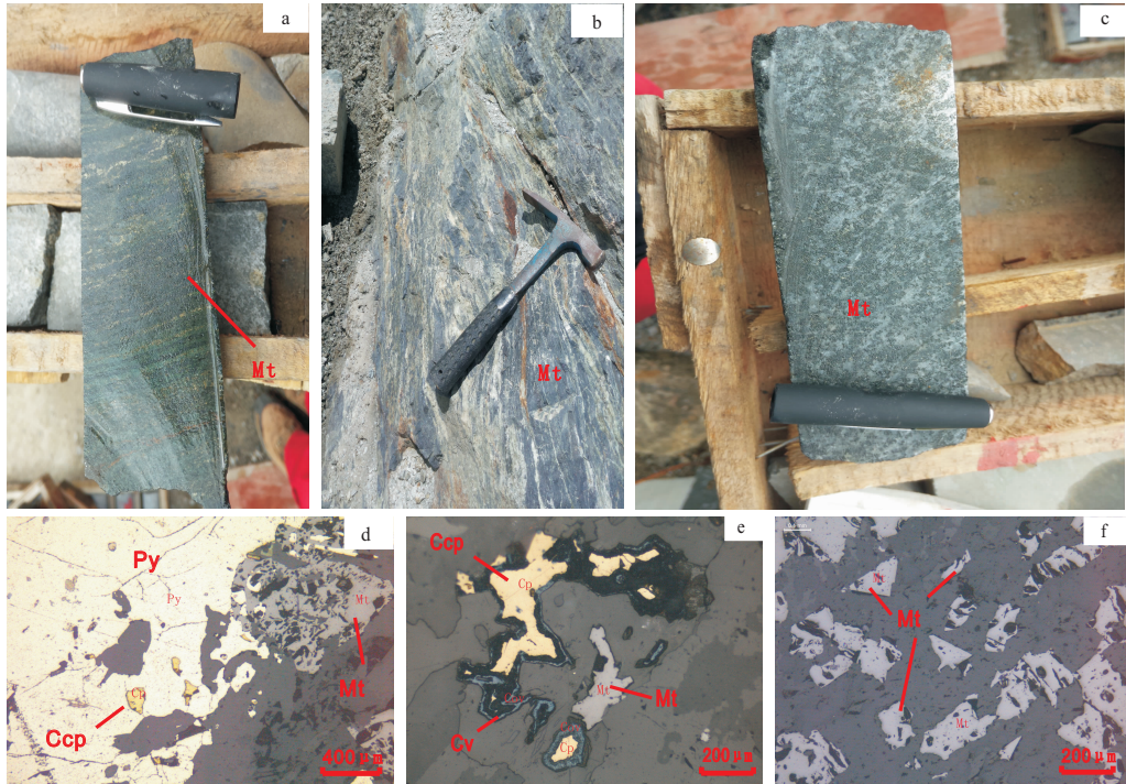
a. 条带状磁铁矿石,夹黄铁矿脉;b. 条带状磁铁矿石;c. 稠密浸染状磁铁矿石;d. 包含结构:黄铁矿(Py)中包含黄铜矿(Ccp)、磁铁矿(Mt);e. 交代结构:铜蓝(Cv)交代黄铜矿(Ccp);f. 半自形粒状结构磁铁矿(Mt)
