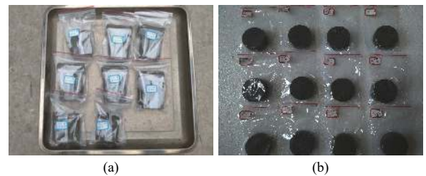
图 2 试样密封养护
