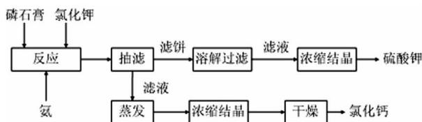
图1 磷石膏一步法制硫酸钾工艺流程
