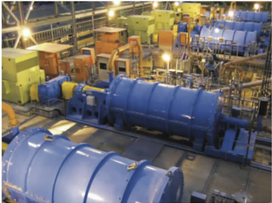
图 10 M10000 艾莎磨机 Fig. 10 M10000 Isa mill
