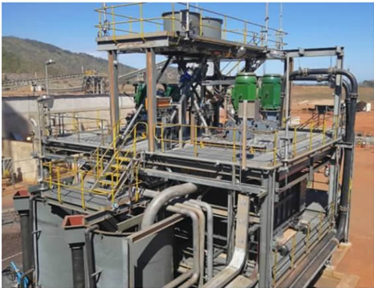
图 13 GJM-30-D 棒式搅拌磨机 Fig. 13 GJM-30-D rod stirring mill
