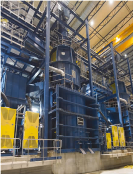
图 8 VTM-4500 立磨机 Fig. 8 VTM-4500 tower mill
