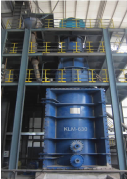
图 9 KLM-630 立磨机 Fig. 9 KLM-630 vertical mill
