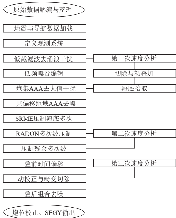
图3 二维地震数据处理流程 Fig.3 Flowchart of 2D seismic data processing
