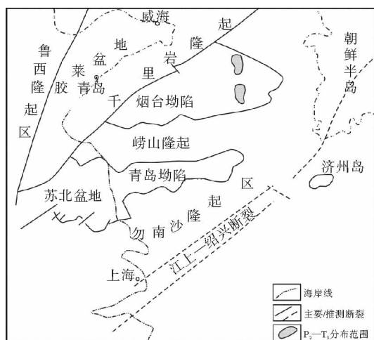
图 1 南黄海盆地大地构造位置示意图(据文献[5]修改)
