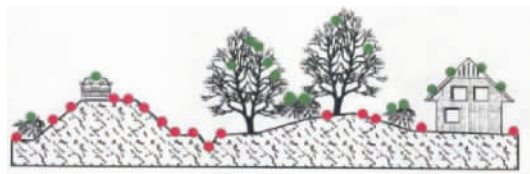
图 3 激光探测地面点分布示意图
