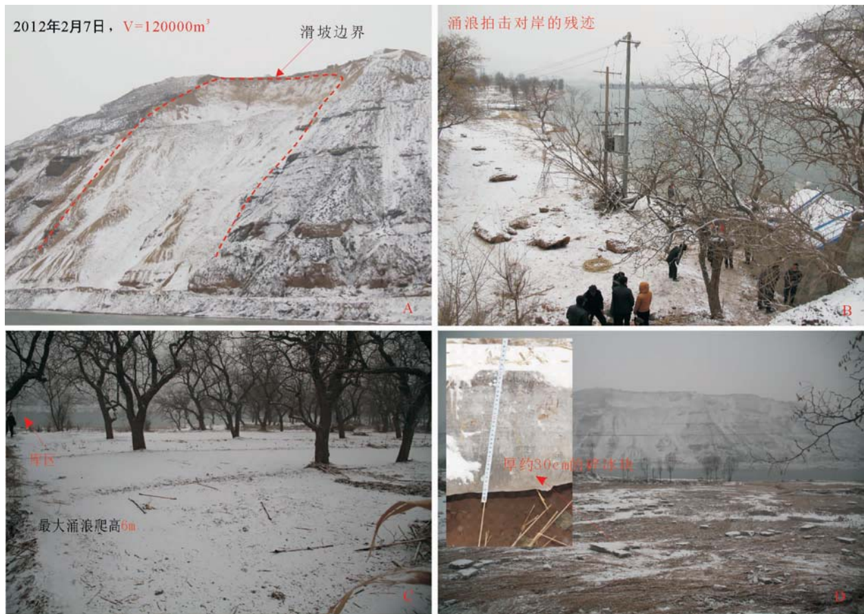
A.2012 年 2 月 7 日焦家崖头滑坡全貌;B.涌浪侵袭后的库区对岸;C.涌浪对岸最大爬高;D.涌浪击碎的冰层
