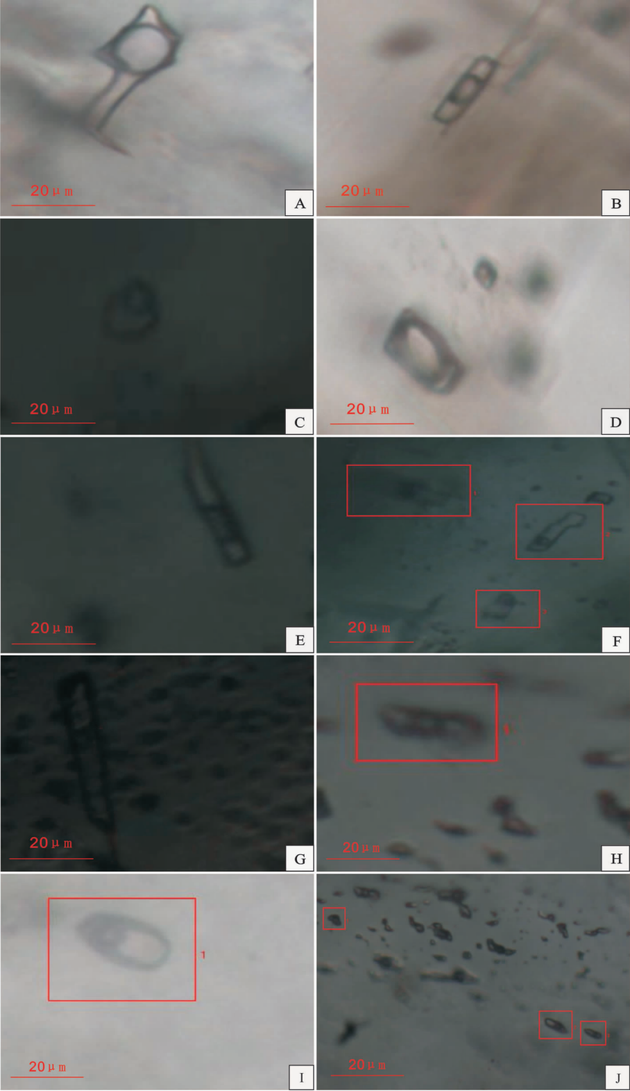
A—方解石早期气相包裹体;B—方解石早期气液包裹体,富气相;C—方解石早期气液包裹体,富液相; D—方解石中期气相包裹体;E—方解石中期气液包裹体,富气相;F—方解石中期气液包裹体,富液相; G—方解石晚期气液包裹体,富液相;H—石英早期气液包裹体;I—石英中期气液包裹体;J—石英晚期气液包裹体
