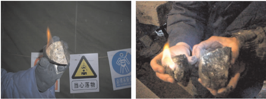
b. DK1 孔取出的水合物样品
