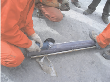
d. PVC 透明 3 层衬管取样
